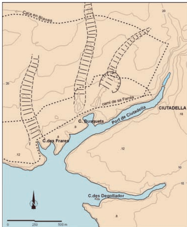
Fig. 11.3. Croquis geomorfològic del port de Ciutadella. A les cales des Freres i d'en Busquets hi afluïen tres paleocanals que van ser interromputs pel camí de sa Farola, construït fa un segle i mig. La vella capital presideix el conjunt des d'un còmode replà a + 18-20 m.
