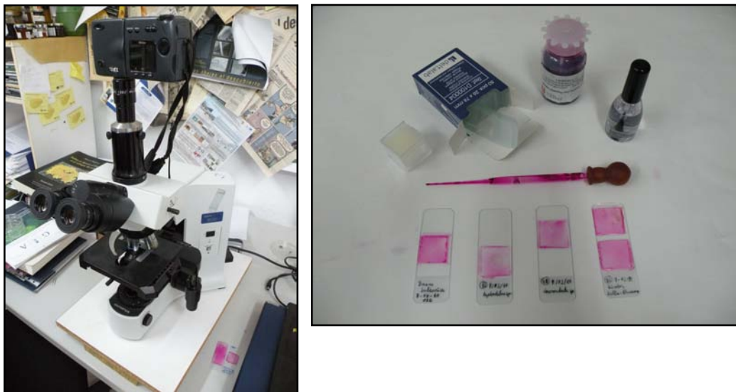
Figura 14 i 15. Microscopi Olympus BX-41 (esquerra) i material necessari per a la preparació de les mostres. Hi apareixen quatre preparacions de pol·len que formen part de la palinoteca (dreta).
