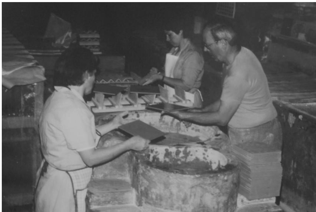
Fig. 10. “Blanquers” envernissant a mà. Imatge extreta d'ESTALL POLES, V., La industria cerámica en Onda. Las fábricas. 1778-1997 , Ajuntament d'Onda, Onda, 1997.
