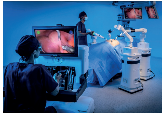
Figura 3: Consola del sistema robótico Versius. (Imagen cedida por CMR surgical).
