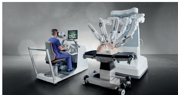
Figura 8: Sistema robótico Avatera, de izquierda a derecha: Consola con visor binocular y columna móvil de la que dependen los cuatro brazos robóticos. (Imagen cedida por Avateramedical).
