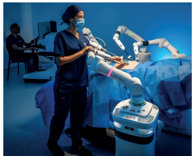
Figura 4: Módulo independiente con brazo robótico Versius. (Imagen cedida por CMR surgical).
