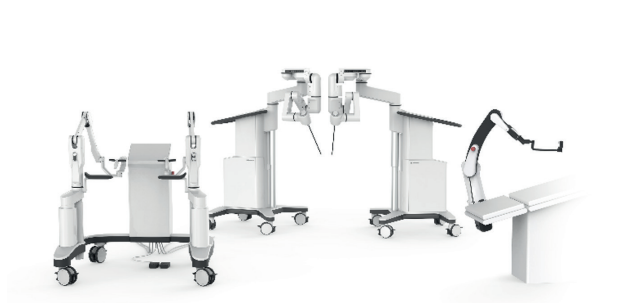
Figura 9: Sistema robótico Dexter, de izquierda a derecha: Consola del sistema, dos módulos independientes con brazos robóticos y soporte robótico de cámara endoscópica. (Imagen cedida por Distalmotion).
