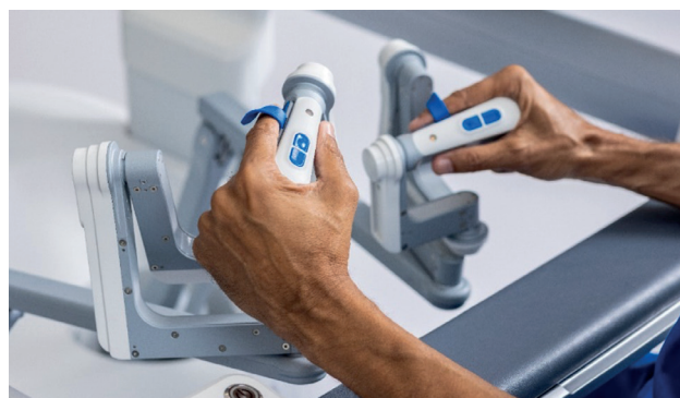
Figura 6: Mandos de control del sistema robótico Hugo. (Imagen cedida por Medtronic).
