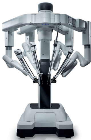
Figura 2: Columna móvil con brazos robóticos del sistema Da Vinci. (Imagen cedida por Intuitive).
