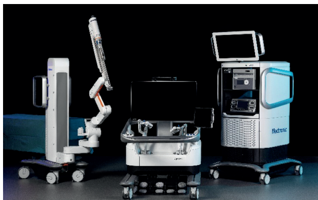
Figura 5: Sistema robótico Hugo, de izquierda a derecha: Módulo con brazo robótico, consola con mandos y pedales, unidad central de procesamiento con pantalla, sistema de insuflado y generador electroquirúrgico. (Imagen cedida por Medtronic).
