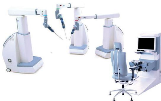
Consta de un sistema modular independiente de hasta 4 brazos robóticos, con una base sobre ruedas que permiten su desplazamiento por el quirófano.
