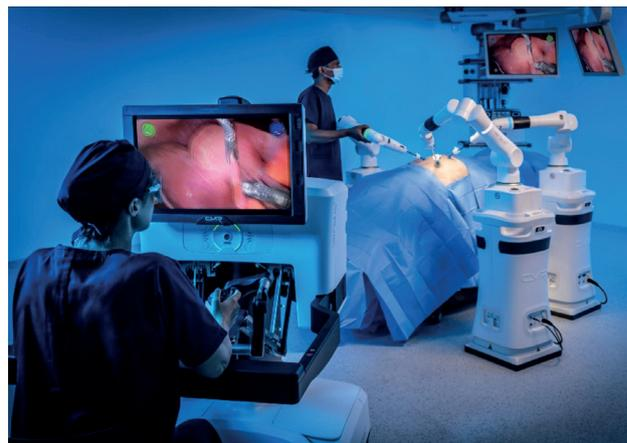
Consta de una cámara endoscópica de 10 mm que ofrece una visión 3D que requiere del uso de gafas 3D por parte del cirujano. No está disponible actualmente la posibilidad de fluorescencia. El movimiento de la cámara se controla desde los mandos de la consola. El resto del equipo al lado del paciente tiene visión de la cirugía mediante una pantalla 2D.
