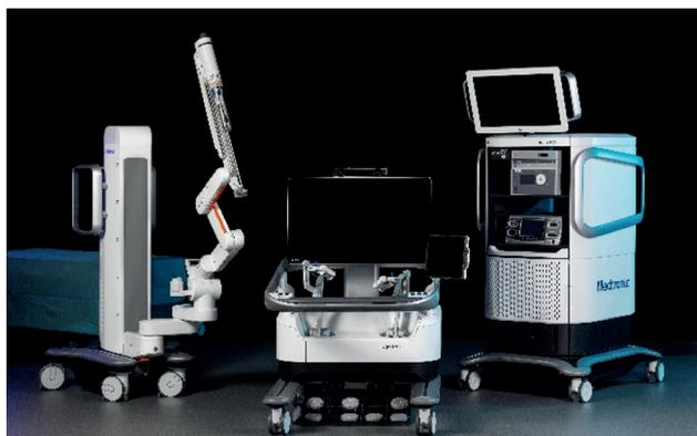
3D con marcadores reflectantes por parte del cirujano. El control de la cámara se realiza desde los propios instrumentos de la consola, combinando el movimiento con los mandos y el pedal correspondiente. Dispone de un monitor interactivo con un multiplicador de la rotación y ajustes de escala de movimiento.
