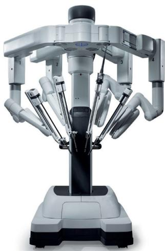
EL Da Vinci Xi tiene un amplio catálogo de instrumentos que permiten una articulación con 7 grados de libertad mediante la tecnología Endowrist®. El tamaño de los instrumentos permite su uso a través de un trócar de 8 mm, a excepción de la endograpadora robótica que precisa un trócar de 12 mm. Dispone de una amplia variedad de instrumentos que incluyen diferentes pinzas de agarre y portaagujas, tijeras, pinzas bipolares, pinzas selladoras, aplicadores de clips y endograpadoras.
