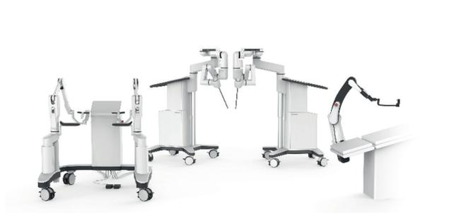
No dispone de cámara endoscópica propia. El control de la cámara puede hacerse por el ayudante de igual manera que en la cirugía laparoscópica o mediante un soporte robótico adaptable a cualquier cámara endoscópica laparoscópica que se fija a la mesa quirúrgica y se controla desde la consola. Esto permite el uso en 2D, 3D o con fluorescencia. Requiere el uso de gafas para la visión en 3D.
