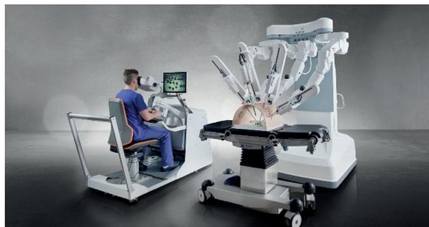
Los instrumentos disponibles son un disector tipo *Maryland* bipolar, unas tijeras de *Metzenbaum* bipolares, una pinza de agarre atraumática y un portaagujas, todos de un solo uso y de tamaño de 5 mm que permiten 7 grados de libertad en la punta del instrumento.
