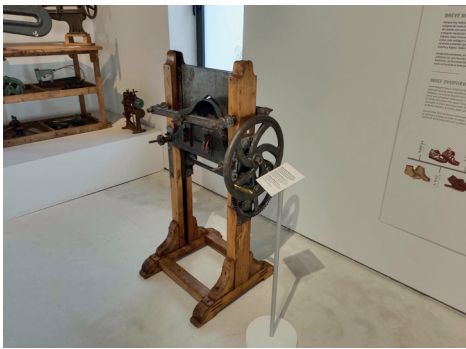
Figura 4. Màquina semimanual d'emmotllar, 1940.
