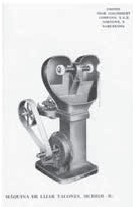
Fig 4. Màquina de polir tacons. Catàleg, vers 1910. Col·lecció particular Fig 5. Màquina de polir tacons. Museu del Calçat i de la Pell
