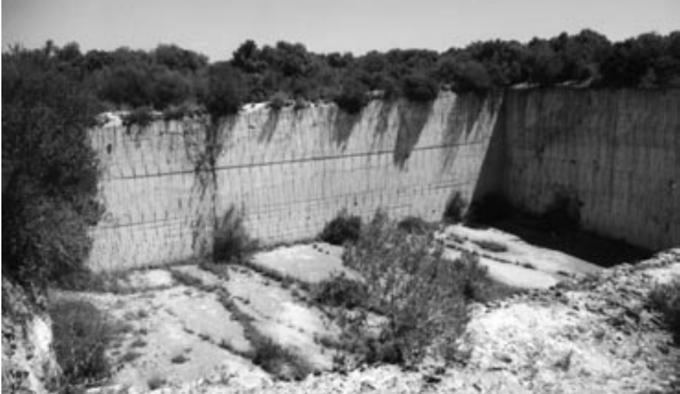
Fig. 5–. Sa Pedrera des Cantons, abandonada, amb les empremtes deixades en la paret per la màquina regatadora. Un cub enclotat dins la garriga. Generacionalment més moderna que la Pedrera des Senyors. L'accés és a la banda esquerra de la fotografia. Foto: G. Alomar–Garau.
