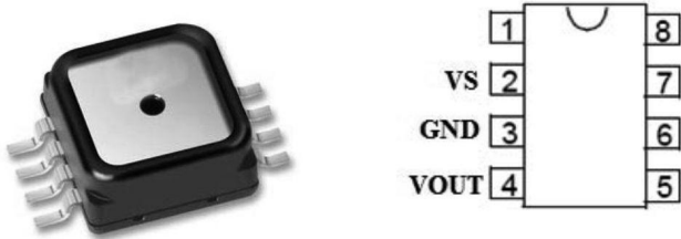
Fig. 13 Sensor de pressió MPXH6300A i disposició dels pins [1]
