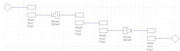
Fig. 4 Circuito formado por cuatro líneas de transmisión.
