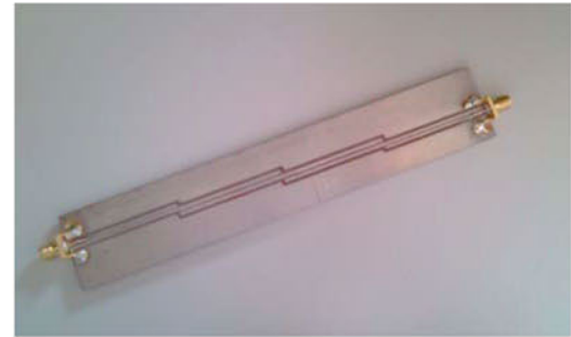
Fig. 6 Placa fabricada del filtro pasabanda.
