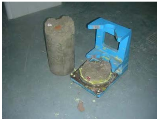
Fig. 3 Proveta amb 100% d'AMR a la dosificació, no va ser possible el seu refrentat.
