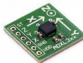
Figura 1: Acceleròmetre ADXL330 integrat a una PCB
