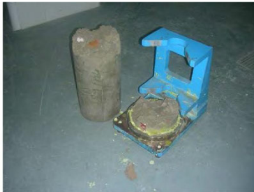
Fig. 3. Probeta amb 100% d'AMR a la dosificació, no va ser possible el seu refrentat.
