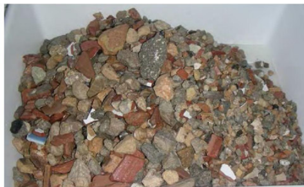
Fig. 1 Àrids mixtos reciclats, fracció 8/40 mm
