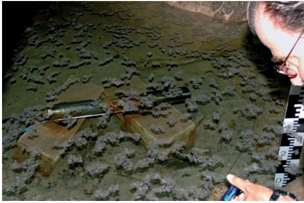
Figura 3: Presència de calcita flotant als llacs anquihalins de la Cova de sa Font. També es poden observar, submergits dins les aigües, diversos equipaments per al seguiment del nivell dels llacs i la seva salinitat.
