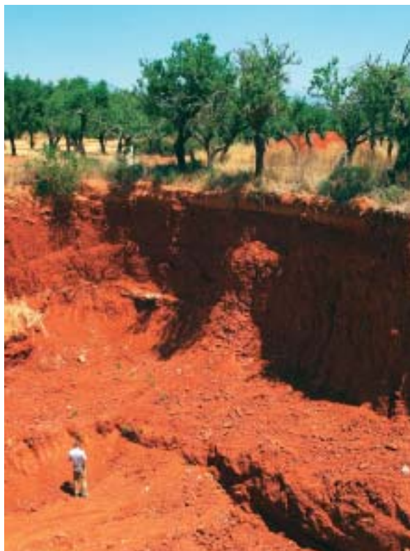
Foto 1: Clot de sa Terra o coves de Can Guidet, a la contrada de Can Vic al NE de la vila de Pòrtol. Aspecte actual de les pedreres des d'on d'èpoques remotes s'extreu l'argila per elaborar la terrissa. Encara s'aprecia la notable potència del dipòsit de sediment.
