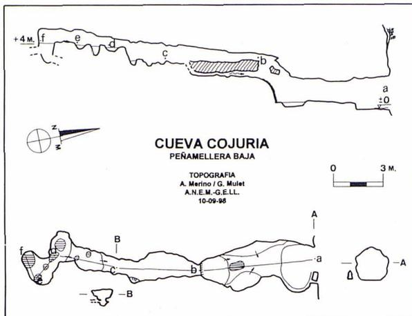
La génesis está relacionada con una fractura de dirección NNE-SSW y una serie de juntas de estratificación afectadas por la misma. Morfológicamente destacan las formas de corrosión por circulación de agua y la existencia de una serie de pequeñas pozas que tapizan parte del suelo de la galería.
