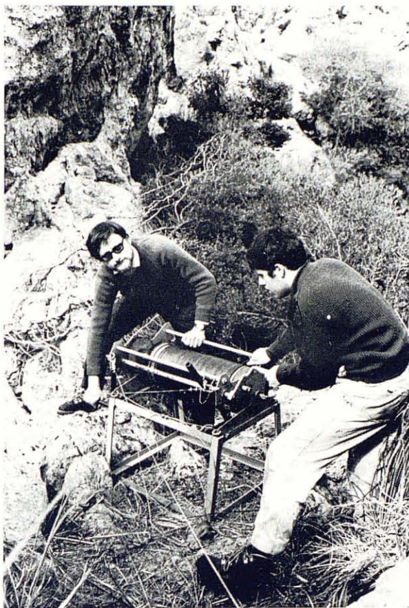
Instal·lació exterior del torn emprat pel descens del pou inicial de l'Avenc de s'Aigo (Escorca), durant la Setmana Santa de 1970. A la fotografia: n'Oriol de Bobes i en Joaquín Ginés.
