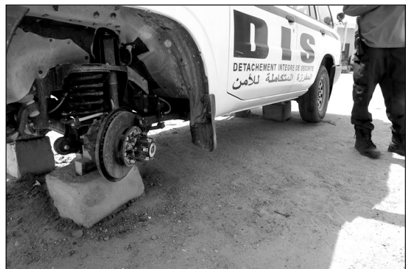
Vehículo del DIS con el sistema de suspensión dañado. Bahai.
