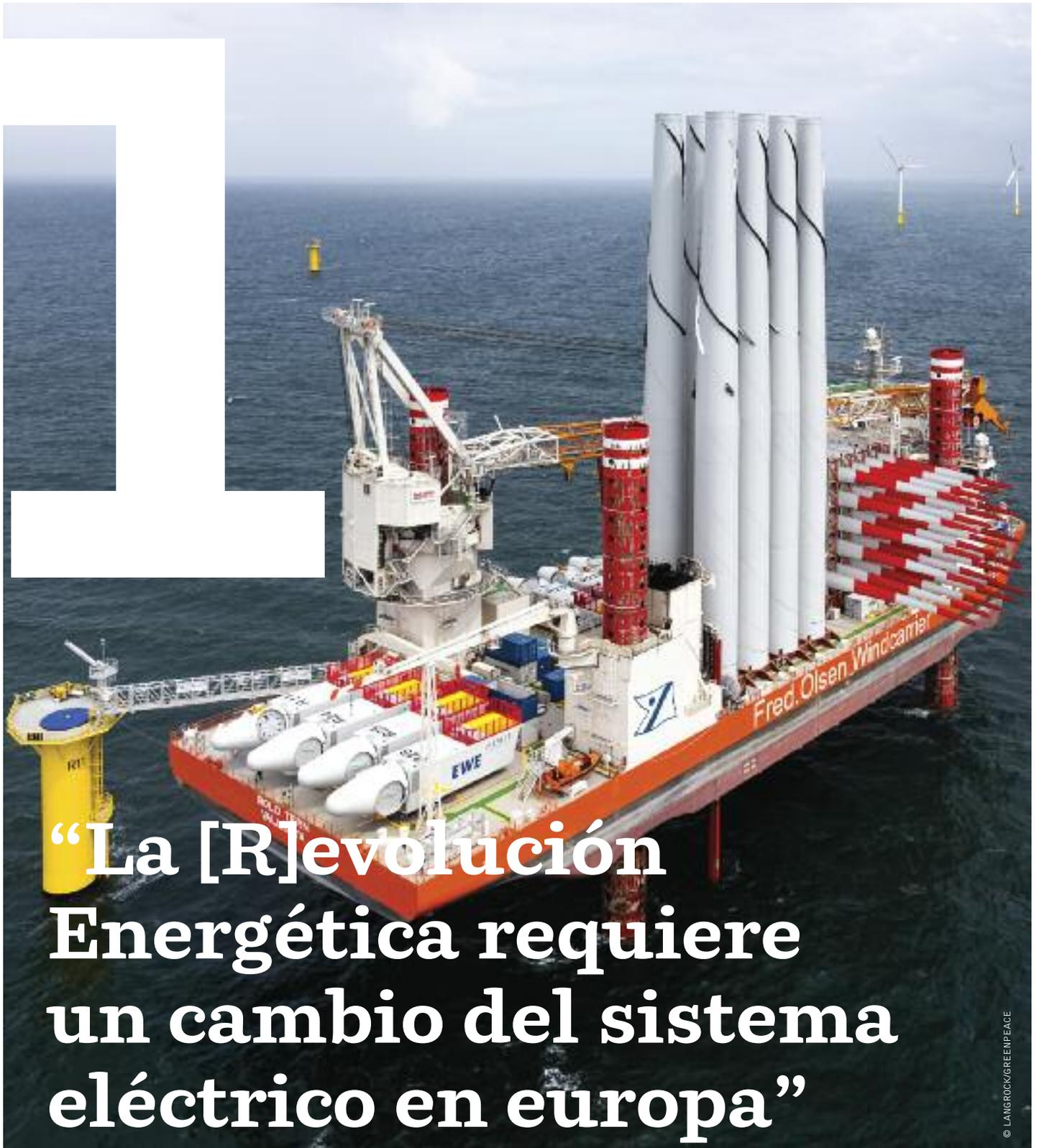
**imagen** BORKUM RIFFGAT, TAMBIÉN CONOCIDO COMO OWP RIFFGAT ES UN PARQUE EÓLICO MARINO EN CONSTRUCCIÓN DE 15 KILÓMETROS AL NOROESTE DE LA ISLA ALEMANA DE BORKUM. LAS TURBINAS DE VIENTO ESTÁN CONSTRUIDAS EN UN ÁREA DE 6 KILÓMETROS CUADRADOS. CONSTARÁ DE 30 AEROGENERADORES CON UNA POTENCIA TOTAL DE 108 MEGAVATIOS (MW), Y SE ESPERA QUE GENERE ELECTRICIDAD SUFICIENTE PARA 112.000 HOGARES.
