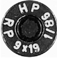
Las marcas que se aprecian en este cartucho identifican al fabricante (HP – el fabricante austríaco Hirtenberger Pat) y el año de fabricación (/86 - 1986). Las marcas también identifican el número de lote exclusivo del cartucho (1), su calibre (9mm x 19, un calibre muy común en pistolas) y el código que permite al fabricante identificar al receptor original (RP - una unidad de la policía alemana).
