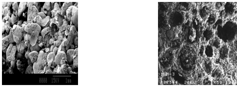
Fig.2 Microfotografías en microscopio electrónico de barrido de marès (izda.) y santanyí (dcha.)
