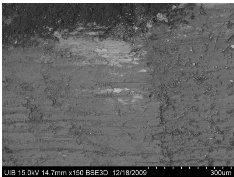
Fig. 3 Segregats de plom de la placa (taques més blanquinoses)
