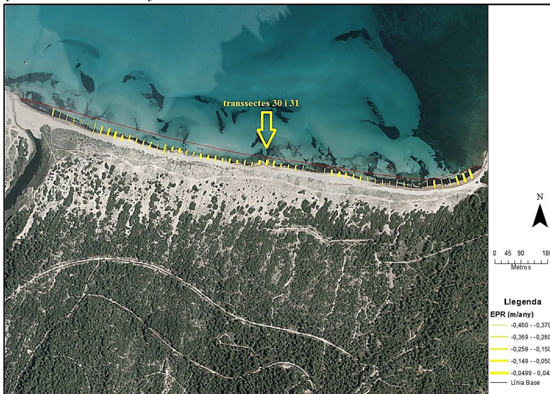
Fig. 11. Variació anual de la línia de costa, càlcul realitzat amb el Digital Shoreline Analysis System, a partir de la creació d'una línia base Onshore i el traç dels transectes.
