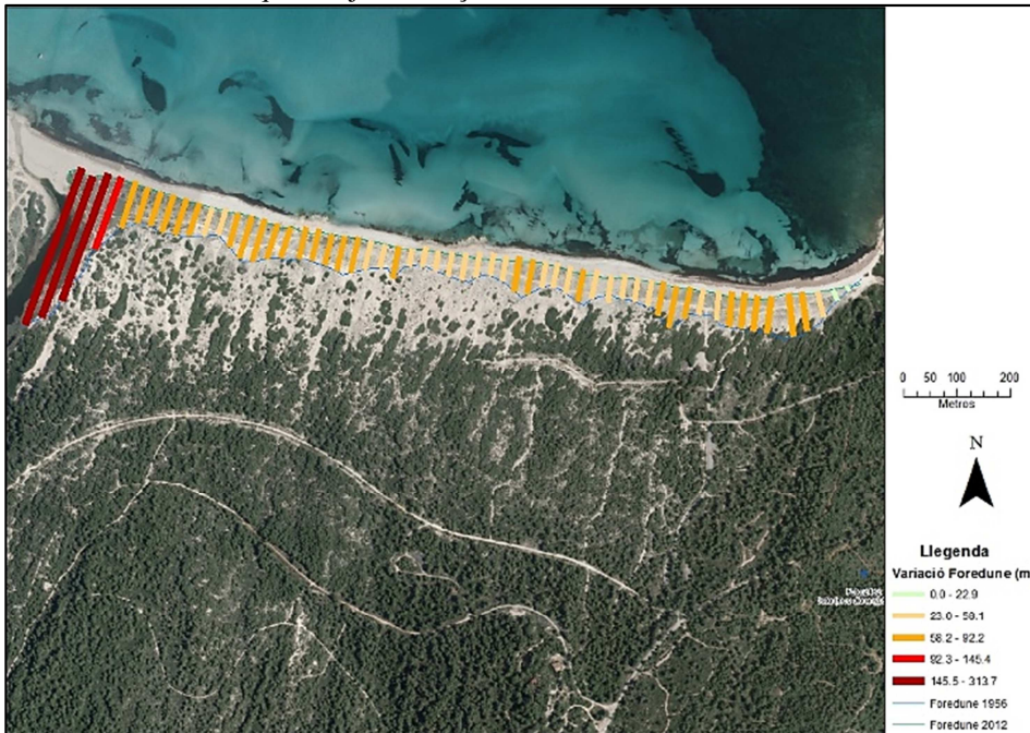
Fig. 13. Variació del front dunar 1956-2012; realitzat amb la extensió Digital Shoreline Analysis system (DSAS). La base cartogràfica es correspon a la fotografia de 2012.
