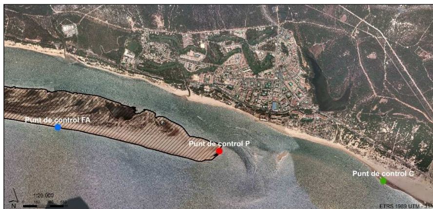
Fig. 5. Punts de control de l'anàlisi que permeten establir progració o retrogració de la fletxa. Fig. 5. Monitoring points of the analysis which enable to establish progradation or retrogradation of the spit.
