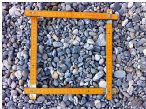
Fig. 2. Malla de 20 cm de costat utilitzada per delimitar les mostres de còdols.
