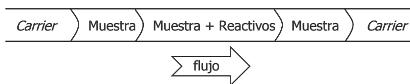
Figura 3.2. Esquema del tipo de inyección sándwich multiconmutada.
