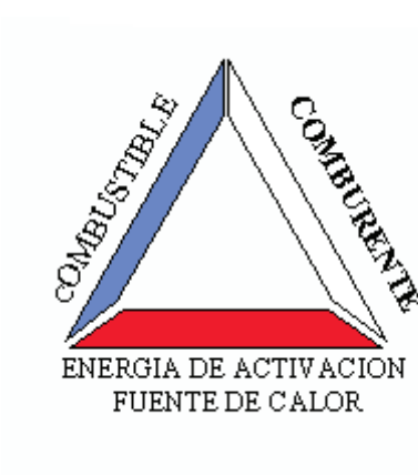
Esquema A IX.5. Triángulo de fuego en el que "no" hay comburente.
