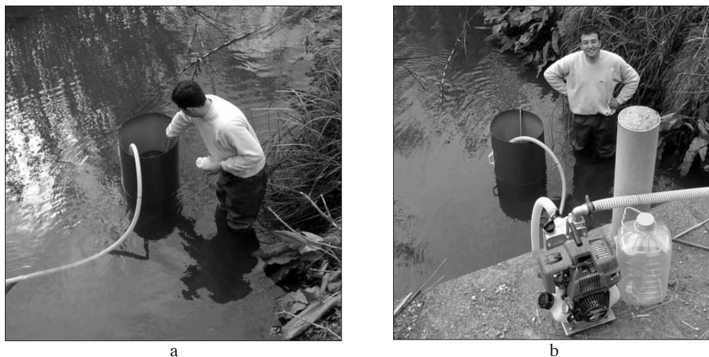
Fig. 2. Mostreig de l'emmagatzematge temporal de sediment fi. Els procediments de l'agitació (a) i la bomba d'extracció d'aigua (b).
