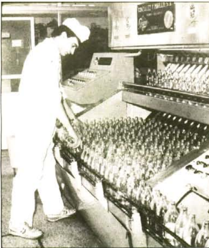
Els envasos de vidre sofreixen un procés d'esterilització d'aigua calenta amb sosa.
