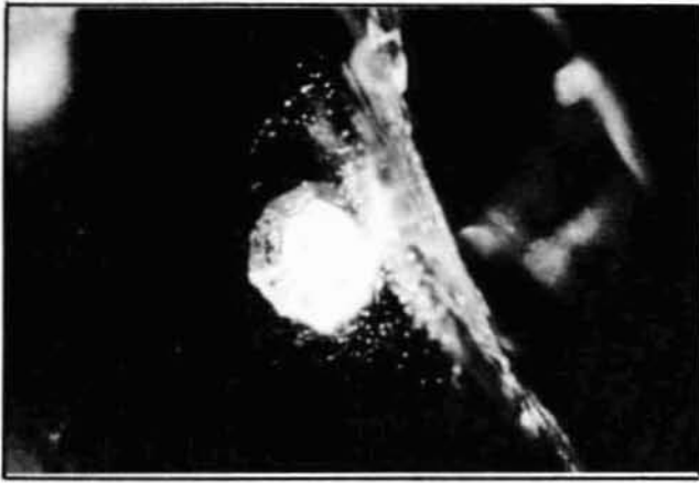
Fig. 1.—Cristal de apatito (1), de contorno exagonal, en contacto con una fisura (2), típico de los rubíes de Siam.
