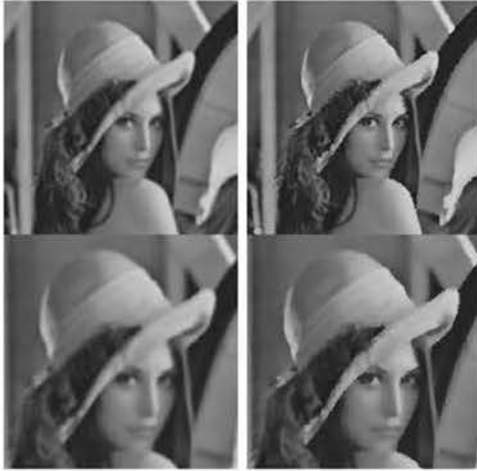
Fig. 7. A l'esquerra tenim dos emborrnaments de l'imatge original, i a la dreta tenim la imatge després de 40 iteracions amb k = 0.025 .
