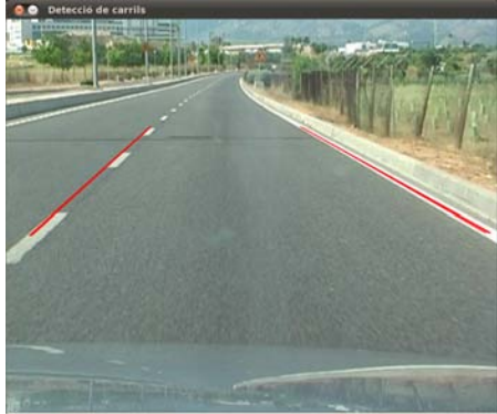
Figura 4. Doble aplicación de la transformada de Hough
