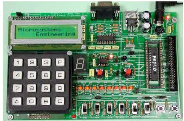
Fig. 1 Fotografía del entrenador utilizado (PIC 16F876).
