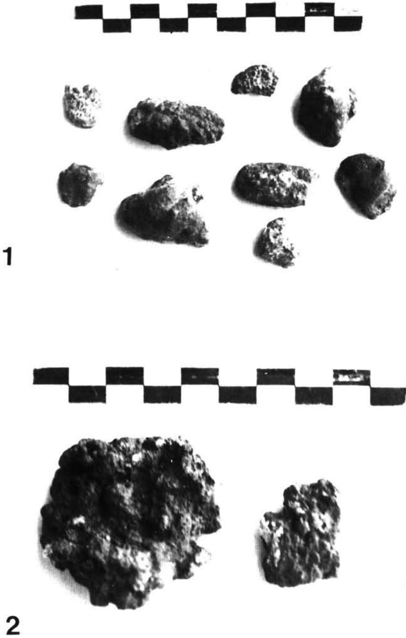
Lámina 2. Mineral de hierro (1) y restos de fundición de hierro (2).
