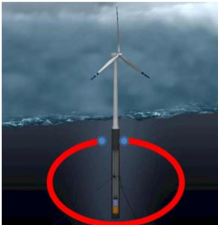
Esquema 17. Despliegue de una barrera para contener grasas y aceites procedentes de la góndola de un aerogenerador.
