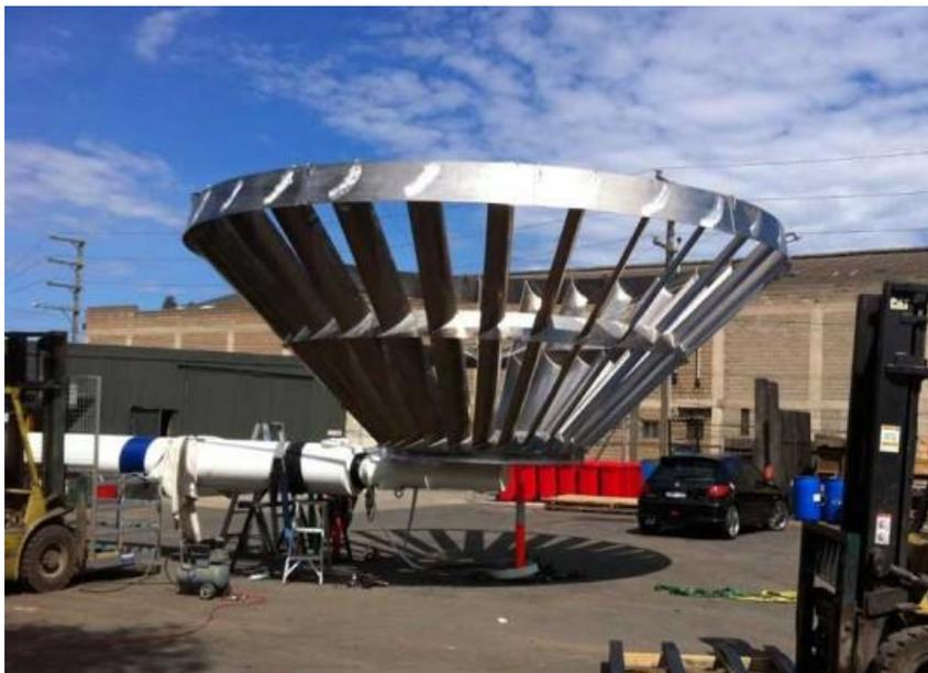
Fotografía 1. Aerogenerador especialmente diseñado para la disminución del ruido y el impacto aviar.
