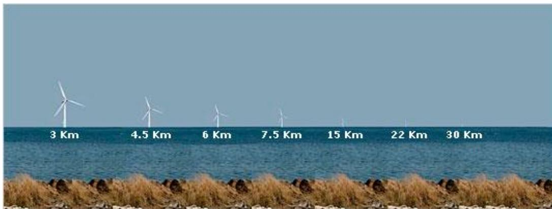
Esquema 13. Visibilidad de un aerogenerador a distintas distancias de la costa. Fuente. <http://antonionarejos.wordpress.com/2011/04/15/impacto-visual-de-parques-eolicos-marinos-offshore/>
